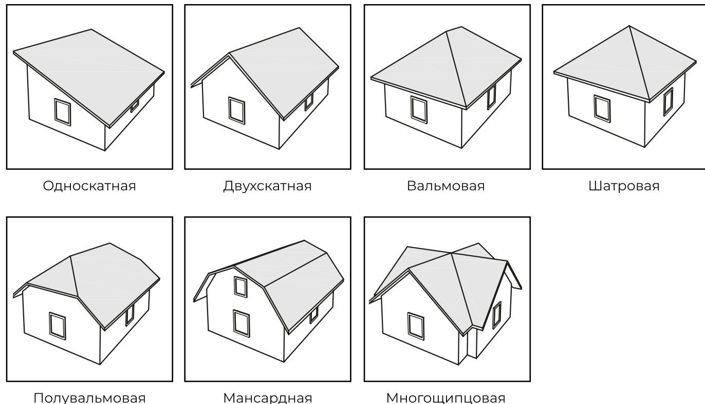
Рисунок 2.3 – Формы крыш, допустимые для применения только черепицы Опал
